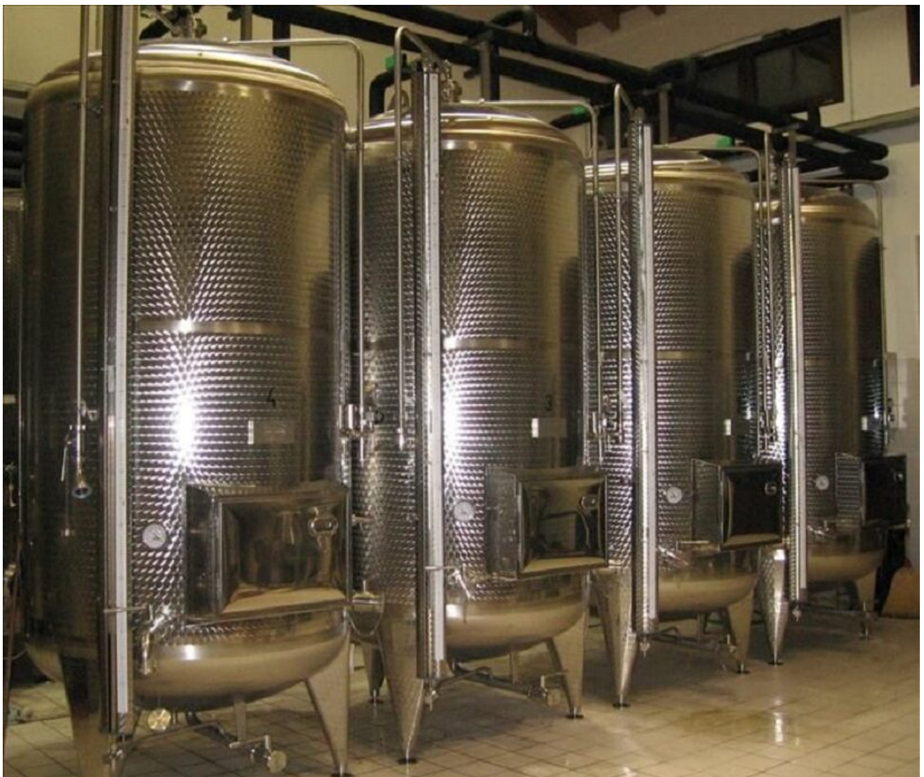
Autoclavi per il metodo Charmat
